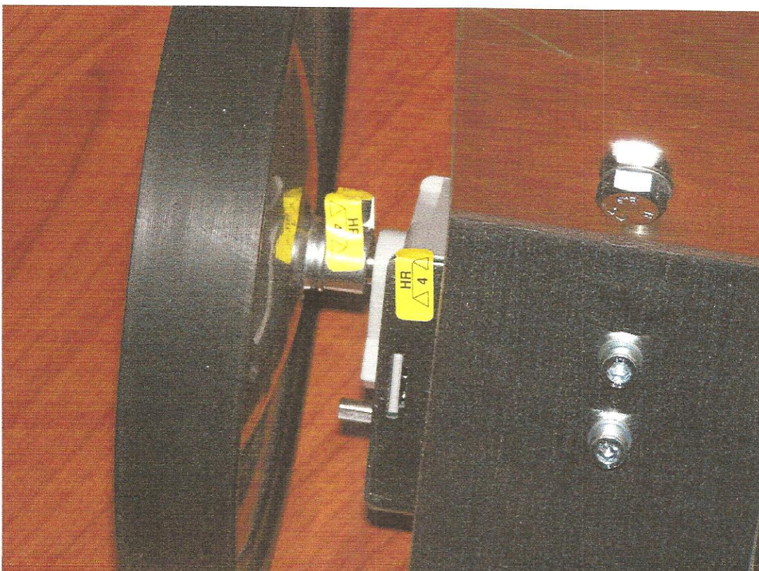
Slika 2. način zaštite spoja mjernog kotača i kućišta pokaznog uređaja.
